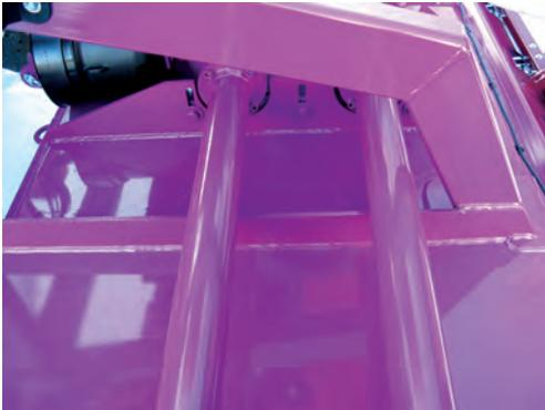
Höchste Lebensdauer aufgrund komplett durchgeschweißter Nähte.
