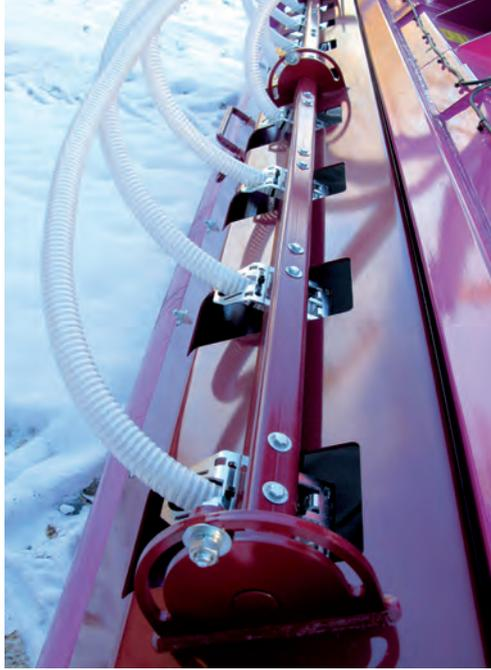
nach dem Rotorsystem, ein effektiver Steinschlagschutz für die Prallteller der Saatguteindosierung eingearbeitet. So brauchen Sie keinen Bruch oder Verbiegen der Prallteller befürchten. Weniger Wartung, weniger Kosten.
